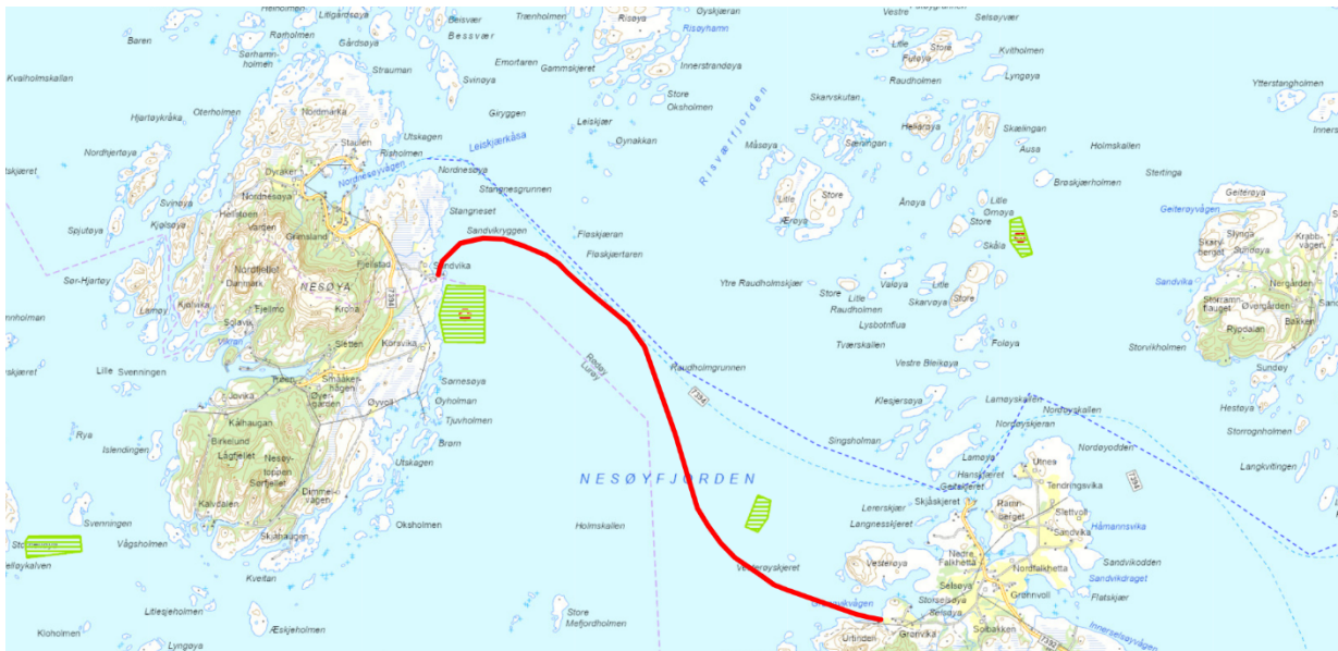
Figur 2 Planlagt etablering av sjøkabel mellom Sandvika på Nesøya og Grønnvika på Selsøya. Hvor fremføringen av sjøkabelen er planlagt installert ut fra Grønnvika på Selsøya i vestlig retning før den dreier nordvest ved Vesterøyskjæret mens den følger en eksisterende sjøkabel og legges langt nok vest for å omgå et planlagt oppdrettsanlegg. Omtrent halvveis over Nesøysfjorden svinger den videre nord for å omgå det etablerte oppdrettsanlegget «Korsvika». Ilandføringen av sjøkabelen
