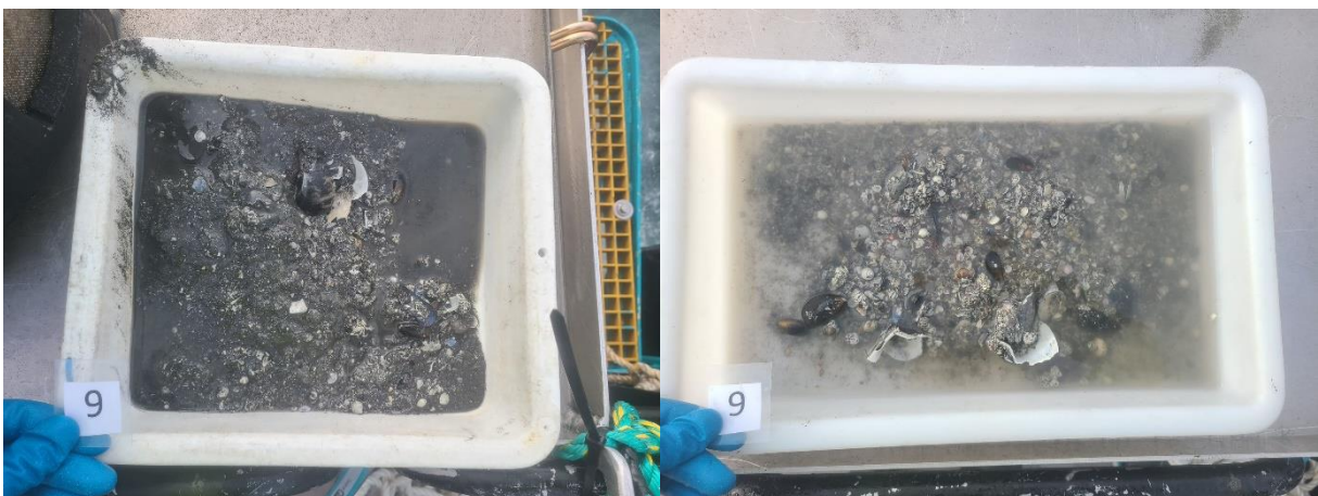
Figur 9: Bilder som viser sedimentet fra stasjon 9 før og etter siling. Sedimentet besto av silt og skjellsand. Foto: Aqua Kompetanse AS.
